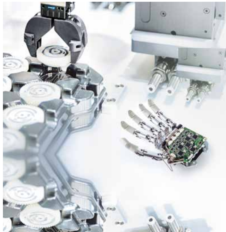
Het gedetailleerde vakmanschap van de duim en vingers van de LifeHand wordt aangedreven door DC-micromotoren van FAULHABER.
